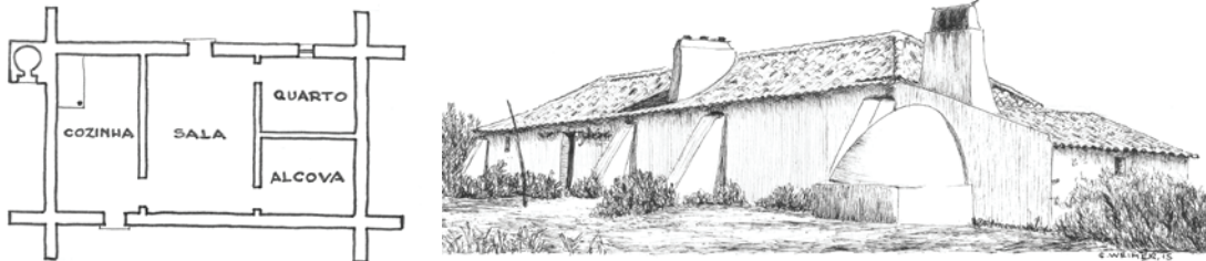
Figura 129: Casa da Arrábida provida de contrafortes denominados de “gigantes”.
