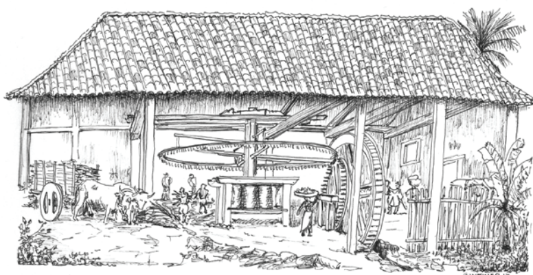
Figura 195: Engenho de água copeira com moenda de cilindros, segundo Frans Post.
