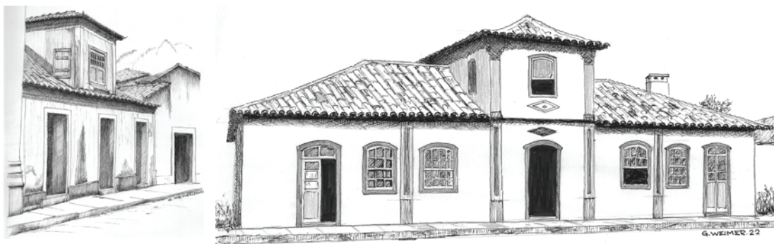
Figura 418: Um pseudo-sobrado em São Luís do Maranhão, com uma “camarinha” embutido no telhado
